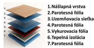
14. Finálna plávajúca podlaha nad vykurovacou skladbou.
